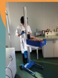
Mini-gerbeur à montée électrique (MG)
