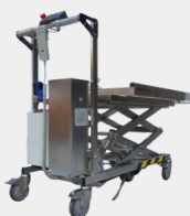
Plateau rapporté sas désinfection Manutention de caisses pour la stérilisation
